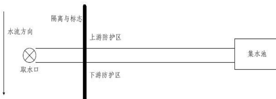
图 2-1 河流、湖库水源保护工程示意图
